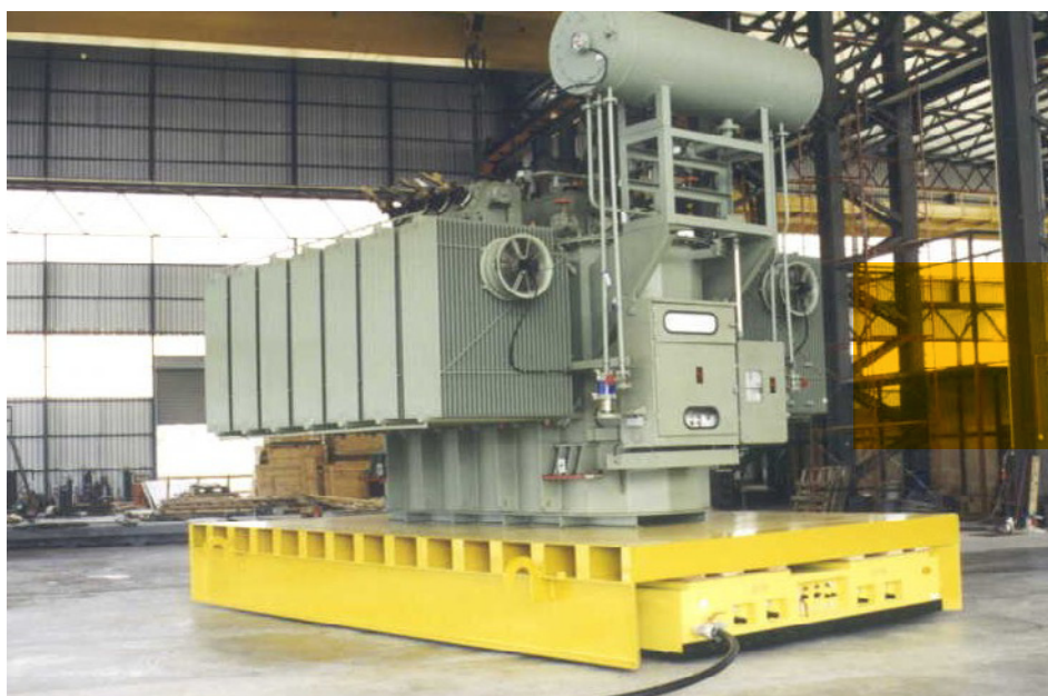
TRANSPORTNÍ PLOŠINA O NOSNOSTI 160 000 kg
